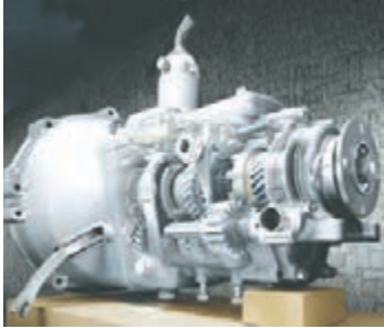
شکل ۱۵ - ترکیب پیچیده‌ای از چرخ‌دنده در جعبه‌دنده خودرو
