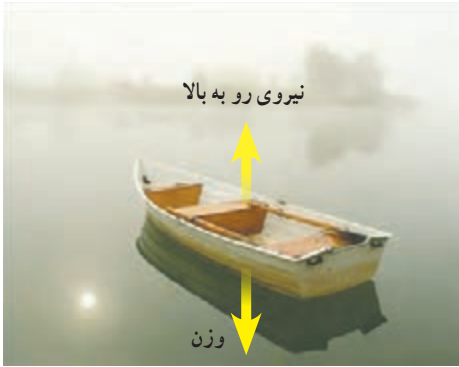
شکل ۵ - نیروی رو به بالایی که از طرف آب به قایق وارد می‌شود هم اندازه با وزن قایق است، بنابراین قایق روی آب به حالت تعادل باقی می‌ماند.
